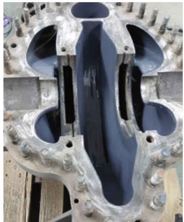
Pumpehus ferdig belagt hos Fuglesangs AS.
