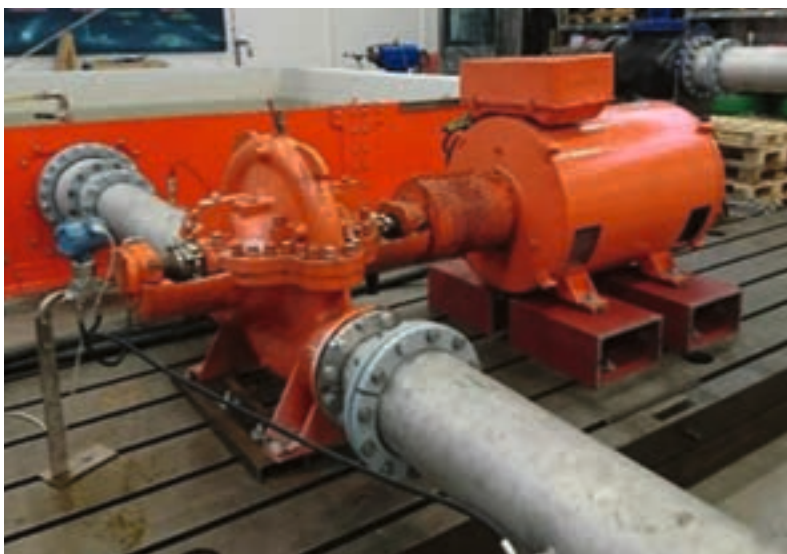
Første pumpe med motor fra Disen pumpestasjon testes i Fuglesangs test-pit på Alna før og siden etter innvendig belegning med epoksy.
