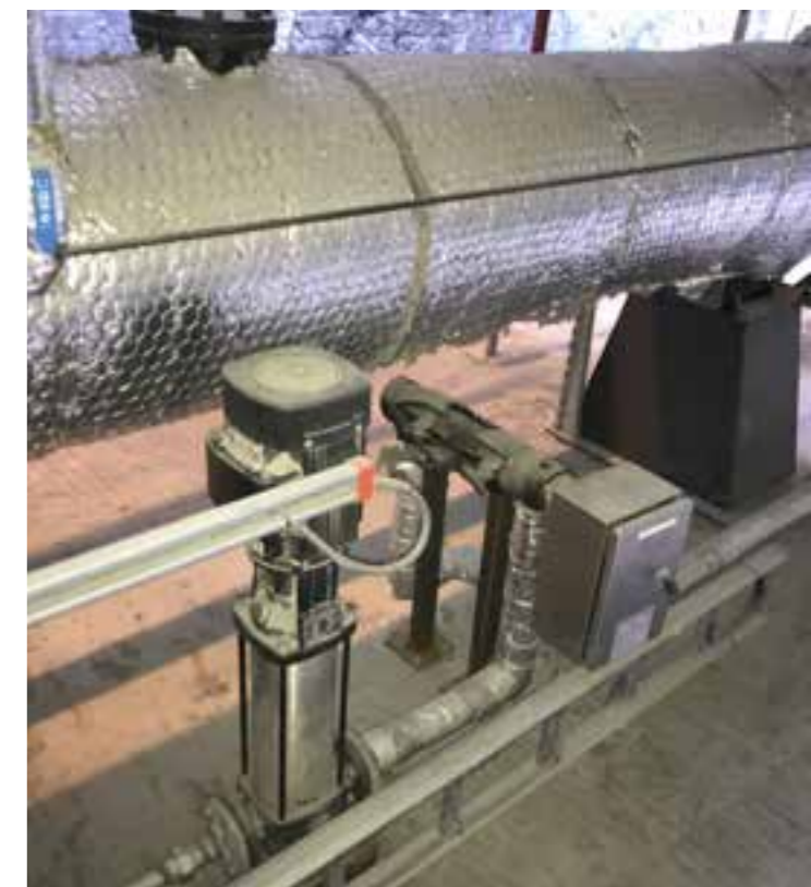
En varmeveksler bestående av fire røykrør i skala 1:1 er testet på avgassen fra sementovnene i Brevik. Testene bekreftet at røykrørkonseptet er egnet for et CO 2 -fangstanlegg.
