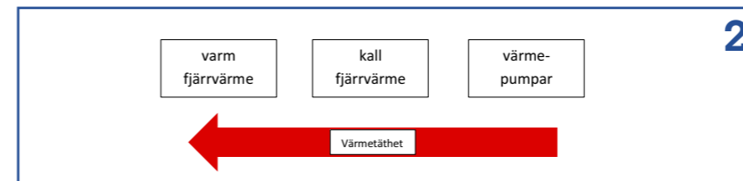
Figur 2 Varmetetheten avgjør hvilken varmeteknologi som er mest konkurransedyktig. Tradisjonell fjernvarme som skal dekke alle varmebehov forutsetter høy varmetetthet, mens varmepumper egner seg bedre i områder med lav varmetetthet. Werner lanserer også en mellomløsning han kaller kald fjernvarme med lav turtemperatur der man kompletterer med varmepumper for å dekke varmebehov på høyere temperaturnivå. Det finnes flere slike systemer i Europa, og flere EU-finansierte forskningsprosjekter (f.eks. FLEXYNETS og RELATED).
