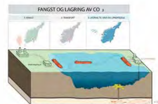
I tillegg til CO 2 -fangstanlegget i Brevik omfatter Langskip-prosjektet skipstransport av flytende CO 2 til en mottaksterminal i Øygarden, og deretter pumpes ned til et stabilt lager under havbunnen i Nordsjøen. Alle disse investeringene og 10 års drift koster visstnok 24 milliarder kroner.
